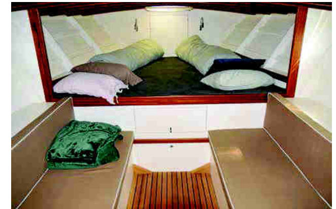
Im Bug schlafen die drei Kinder. Die Doppelkoje für die Eltern ist schnell aufgebaut, indem ein Brett unter der Vorderkoje herausgezogen wird und die beiden Rückenpolster der Sitzbänke eingelegt werden.
