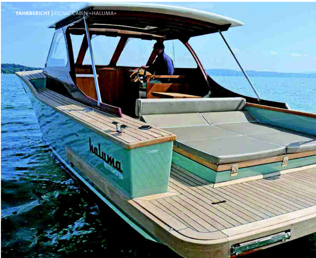
Das Hardtop schützt bei Sonne und Regen und kann bei Bedarf mit einer Persenning rundum geschlossen werden.
